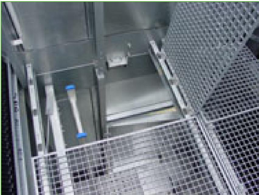
Neben **problemlosem Zugang zur inneren Oberseite des Geräts** bedeutet die installierte innere Plattform auch einfachere und **sicherere** Inspektion und Wartung in Übereinstimmung mit den **EU-Sicherheitsrichtlinien**.
