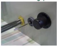
Unsere im Werk eingebauten Heizstäbe halten die Wassertemperatur bei 4° C und fungieren als einfache und wirtschaftliche **Gefrierschutzmaßnahme für das Beckenwasser**. Das Heizungspaket beinhaltet die **Heizstäbe**, einen **Thermostaten** sowie einen **Wassermangelschalter** zum Schutz der Heizstäbe bei zu geringem Wasserstand. Die elektrischen Standardheizstäbe sind für Umgebungstemperaturen bis 18° C geeignet.
