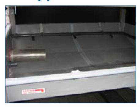
Eine Wannenabsaugung **erhöht die Wasserumwälzung und -bewegung im** Becken und ist für die Verwendung zusammen mit einem <u>Fitrationssystem</u> gedacht. Sie:
