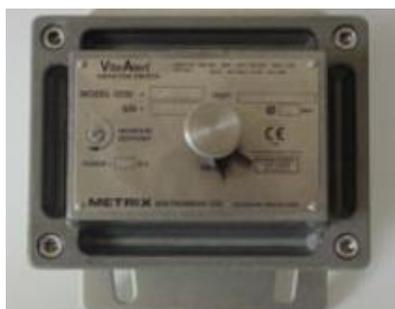
Der Schalter **erkennt übermäßige Vibration des Lüfterantriebs**, die durch eine Vereisung des Lüfters oder einen mechanischen Defekt verursacht wird. Auch wenn er im Werk montiert wird, wird der Schalter während der Installation und Inbetriebnahme vor Ort eingestellt.
