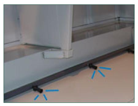
Eine Wannenabsaugung **erhöht die Wasserumwälzung und -bewegung im** Becken und ist für die Verwendung zusammen mit einem Fitrationssystem gedacht. Sie:
