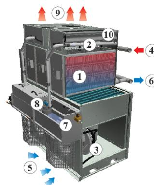
Lorsqu'un module fonctionne **à sec**, la pompe de pulvérisation est désactivée. La chaleur passe maintenant du fluide de process vers l'air ambiant par transfert de chaleur sensible.
