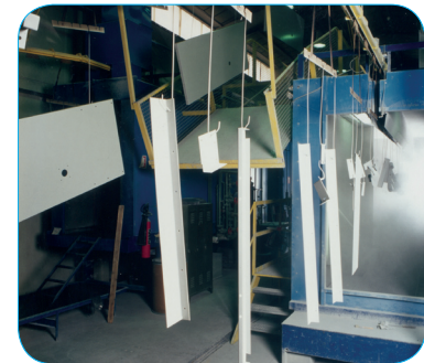
Composants recouverts un à un du revêtement hybride Baltibond
