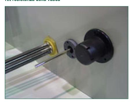
Le nostre resistenze, installate in fabbrica, mantengono la temperatura dell'acqua a 4 °C, agendo come semplice ed economico dispositivo anti-gelo per la vasca dell'acqua. Il kit resistenza include le resistenze elettriche, un termostato e un interruttore di livello minimo per proteggere le resistenze qualora il livello dell'acqua si riduca in modo eccessivo. Le resistenze elettriche standard possono gestire temperature ambiente fino a -18 °C.
