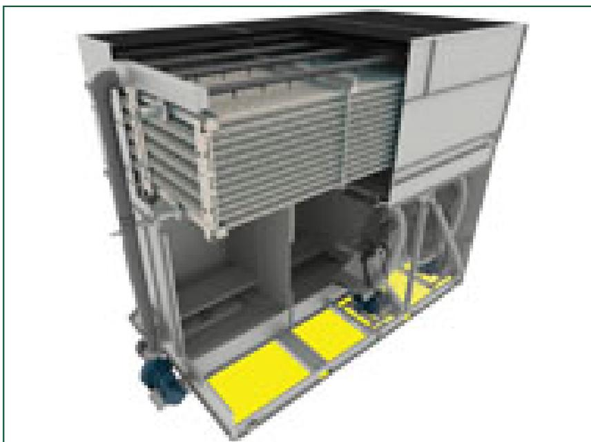
I pannelli di chiusura fondo sono necessari quando l'unità viene montata in elevazione di 30 cm o più e quando l'aria in entrata viene convogliata nell'unità.
