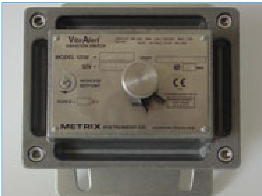
L'interruttore **rileva le vibrazioni eccessive della trasmissione del ventilatore** causate dalla formazione di ghiaccio sul ventilatore o da un eventuale guasto meccanico. Anche se il dispositivo è installato in fabbrica, il punto di commutazione viene regolato sul posto durante l'assemblaggio e l'avviamento.
