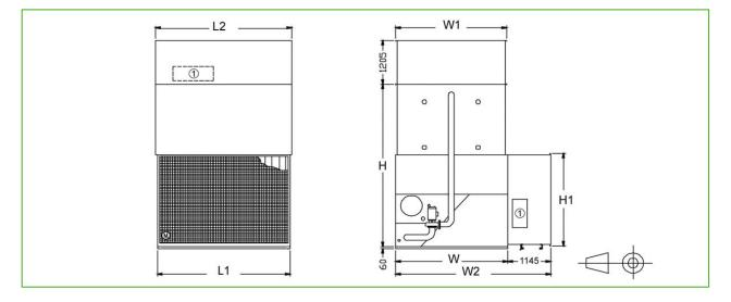
1. Toegangsdeur: L = Toestellengte; W = Toestelbreedte; H = Toestelhoogte (zie Technische Gegevens).
