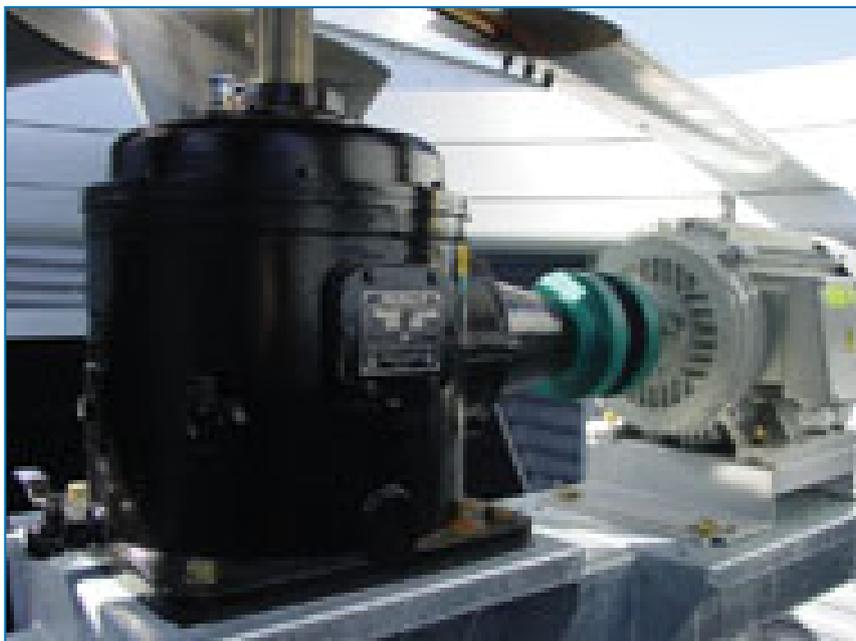
Установленная и выровненная на заводе, система зубчатой передачи с сопряженным мотором - хороший вариант для **некоторых промышленных применений**.
