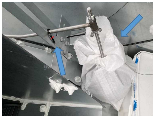
Upevnění a zabalení kulového plováku
