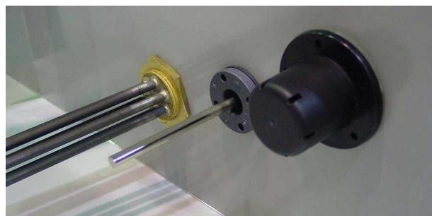
Ohřivač sběrné nádrže
