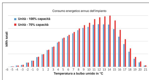
Le unità con pacco di scambio generico hanno una perdita di capacità del 30% ogni anno, con temperatura superiore di 3°C.
