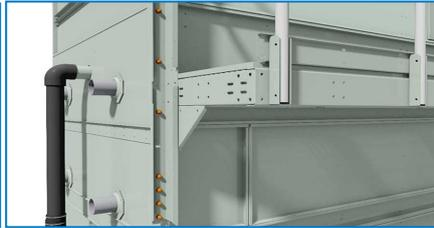
Heben Sie die gesamte Plattform an ihren Platz und befestigen Sie sie mit M12-Montagematerial an den vorinstallierten Halterungen.
