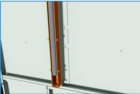
Installieren Sie alle senkrechten Stangen mit den mitgelieferten Halterungen und ziehen Sie sie mit M10-Montagematerial an.
