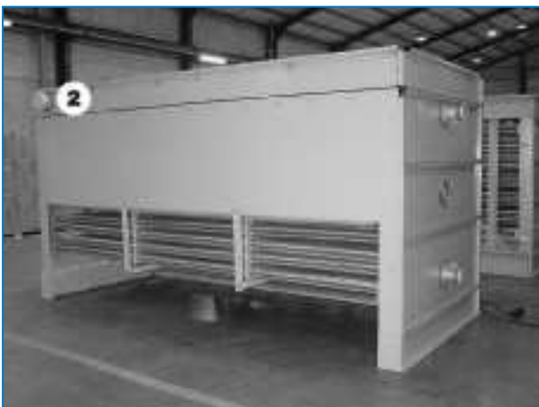
Szivattyú csővezeték csatlakozás a tekercszakaszon
