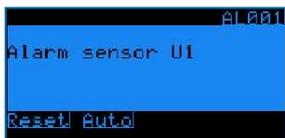
La sonde de pression du condenseur (sur l'entrée U1) est défectueuse.
