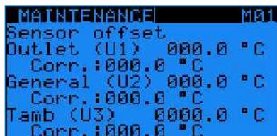
Programmation d'une compensation des sondes (« **Correction mesures** : ») pour corriger les valeurs affichées de la sonde de pression du condenseur (« **Pout (U1)** ») et de la sonde de température ambiante (« **Tamb (U3)** »).
