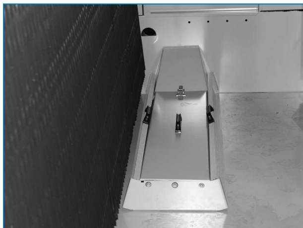
Misa wody zimnej i sito misy
