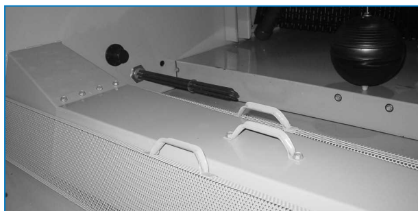
Misa wody zimnej i sito misy
