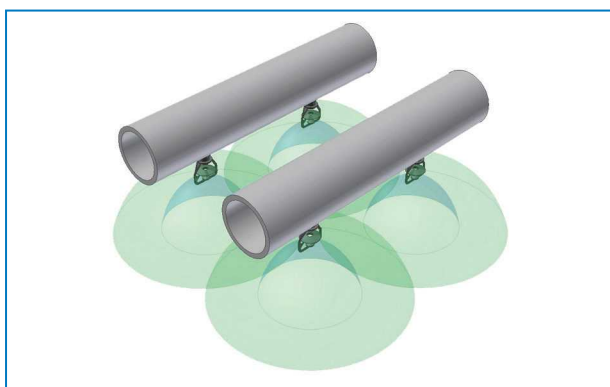
Sposób rozprowadzania wody z dysz w skraplaczu
