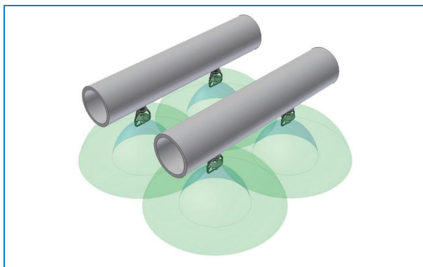
Tipo de distribuição do pulverizador de bocal para condensador
