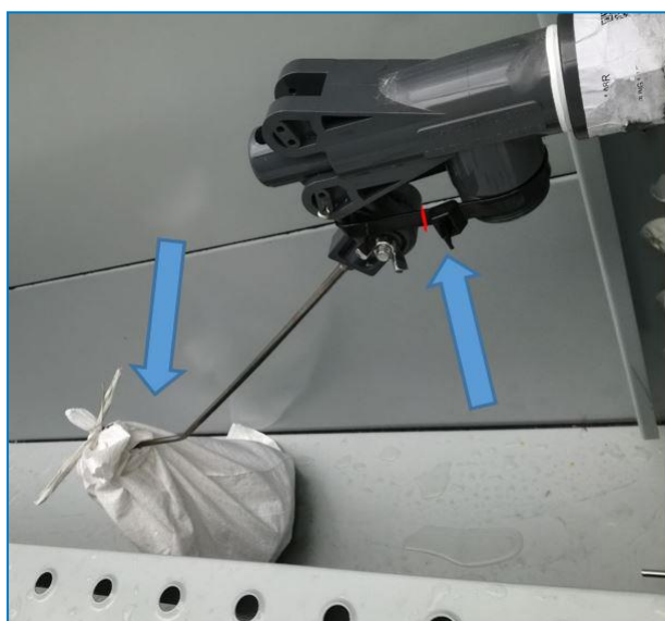
Fixação e envolvimento da boia
