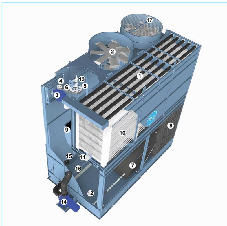
1. Sistema de distribuição de água por pulverização
