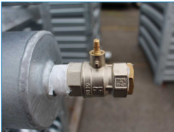
Övre slingkoppling med övertrycksventil på kondensorer.
