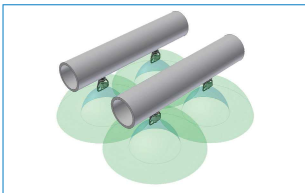
Tip distribucije prskanja mlaznica za rashladni toranj sa zatvorenim kolom
