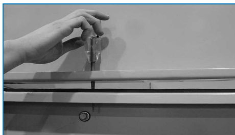
Zastosowanie kołków ustalających do osiowania otworów śrub
