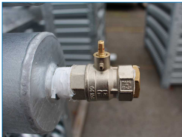
Връзка в горната серпентина с клапан за освобождаване на налягането при охлаждащи кули със затворен кръг с връзки по-големи от ND100.
